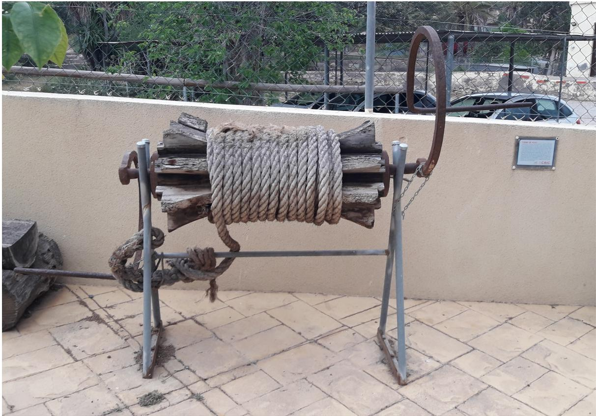
*Fig. 5.- Torno del pozo (probablemente el primigenio) existente en la Finca La Hoya para el abastecimiento de agua de riego. Foto J. Benzal.*
